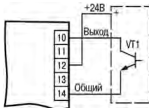
Рисунок 5.3 – Подключение датчиков с n-p-n -выходом
