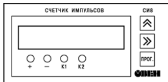
Рисунок 6.7 – Лицевая панель прибора для корпуса щитового (Щ2) крепления
