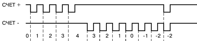
Рисунок 6.2 – Принцип работы входов «Счет+» и «Счет-»
