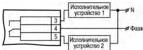
Рисунок 5.5 – Схема подключения нагрузки к ВУ типа Р
